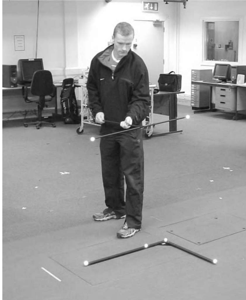
Fig. F2.4. Wand calibration
